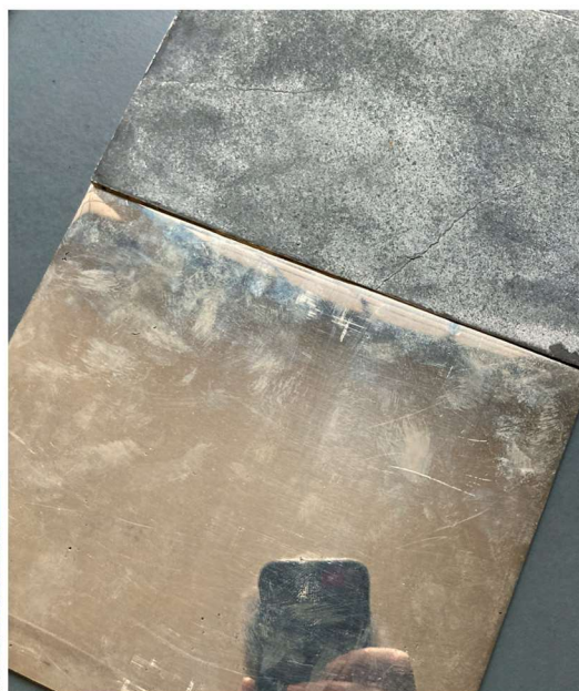
Oben: Neusilber, poliert und roh. Es hat einen schönen warmen Ton ohne belächelt, gleicht dem Steinvorbild und ist doch etwas sehr Anders. Der Alterungsprozess im Aussenraum ist ideal, das Material gut zu reinigen.
